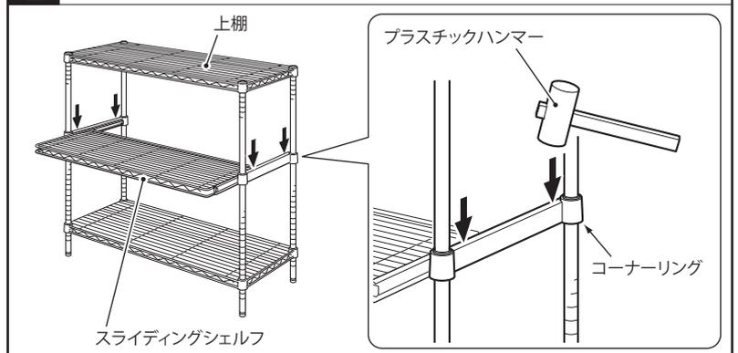
ワイヤーシェルフの組立説明書の組立手順に従って使用する位置に組み付けてください。スライディングシェルフは、棚部を引き出せるよう、向きに注意して組み付けてください。
