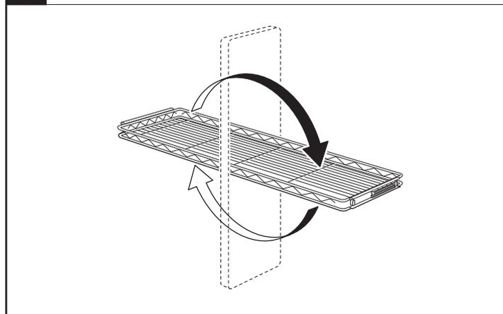
引き出した棚部を長手方向で反転させます。
