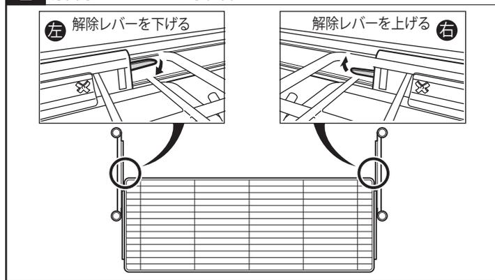
左右レール内側の黒い解除レバーを押します。(解除レバーの操作方向は左右のレールで上下逆になりますのでご注意ください)
