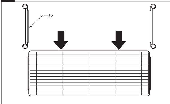
必ず左右均等の力で水平に引き出し、レールから外します。
