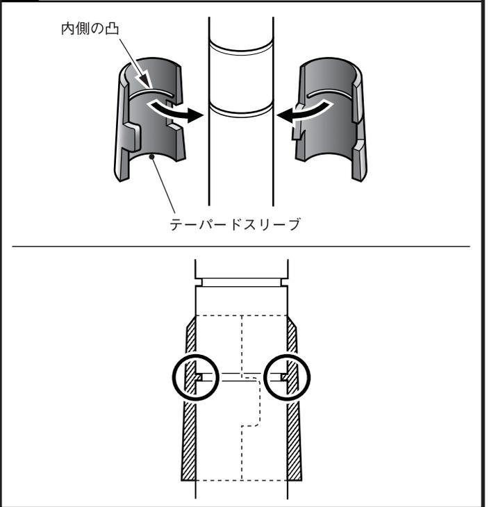
最下段の棚の取り付け位置に、テーパードスリーブの内側の凸とポストの溝が合うように、1枚ずつカチッとセットします。テーパードスリーブは裾の広がっている方を下向きにしてください。※ 棚を一段組み終えるごとにセットしてください。
