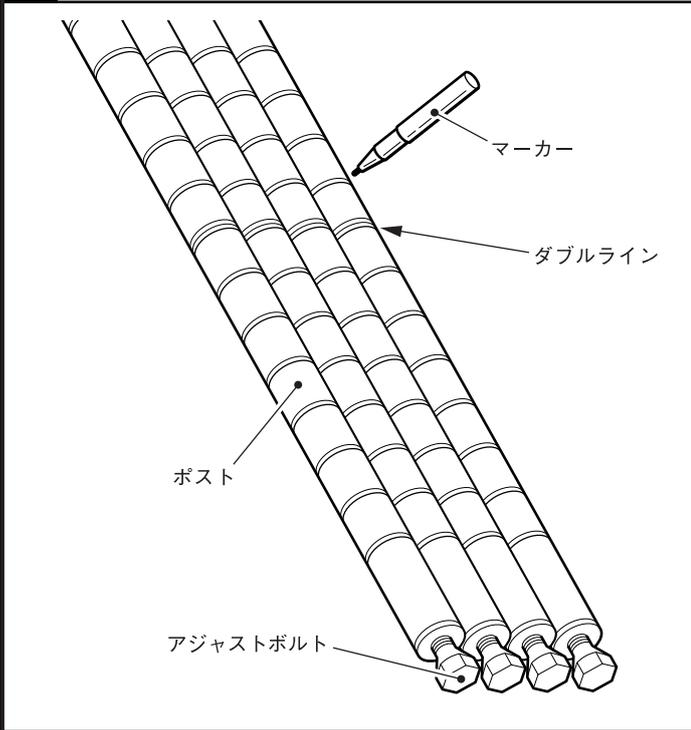
棚に載せる物の大きさに応じて25.4mm（1インチ）ピッチの目盛、あるいは約20cm毎に印されたダブルラインを目安にして、棚の取り付け位置を決めます。この時、マーカ―などでポストに印をつけると便利です。ポストは先端にアジャストボルトのある方が下になります。
