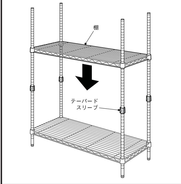
2と同様に、ポストにテーパードスリーブをセットし、棚を上から通して取り付け位置まで差し込みます。すべての棚を同じ要領で取り付けてください。
