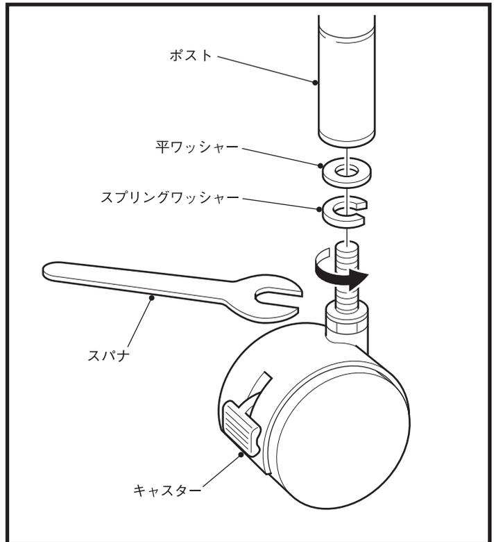
ポスト下部のアジャストボルトを取り除き、キャスターのネジ部にスプリングワッシャー、平ワッシャーの順に入れポスト下部へ差し込みます。付属のスパナで動かなくなるまで締め込みます。
