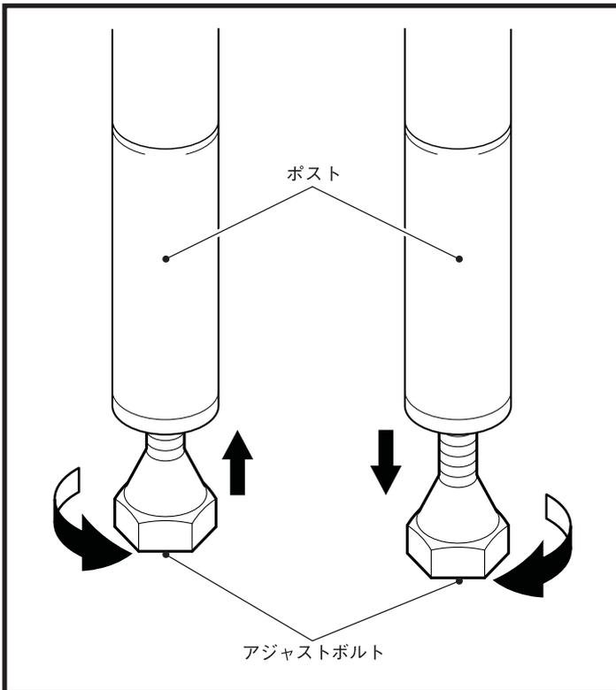
床が水平でないときは、ポスト下部先端のアジャストボルトを回して、ガタつきがないよう調整してください。
